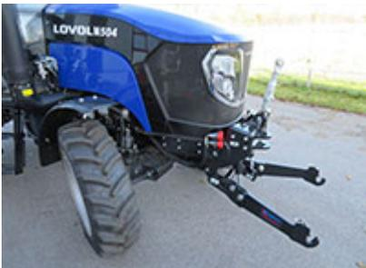
**Frontkraftheber – Art. Nr. FKH-M254: FH 10-4, doppeltwirkend Hubkraft 10kN, Unterlenker Kat. I hochklappbar mit Schnellkuppel-Fanghaken Kat. I inklusive Umschaltventil, doppelt-/ einfachwirkend mit Spindeloberlenker M30 zzgl. Montagekosten**
