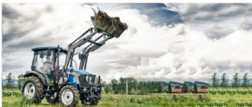
**Industriefrontlader – FL550:** Stabile, werkzeuglos abnehmbare Ladeschwinge mit doppelwirkenden Hubzylindern, Abstellvorrichtung, inkl. Schaufel mit Euro Schnellwechselrahmen, mechanischer Parallelführung, Bedienung über Joystick, robuste Frontlader-Anbaukonsole mit Hinterachsabstützung zzgl. Montagekosten
