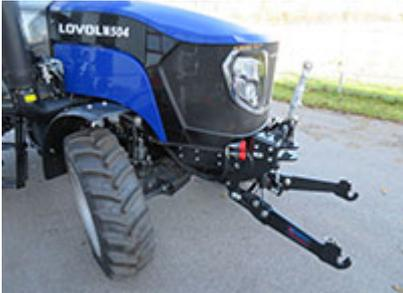
**Frontkraftheber** – Art. Nr. FKH-M354: FH 10-4, doppeltwirkend Hubkraft 10kN, Unterlenker Kat. I hochklappbar mit Schnellkuppel-Fanghaken Kat. I inklusive Umschaltventil, doppelt-/ einfachwirkend mit Spindeloberlenker M30 zzgl. Montagekosten
