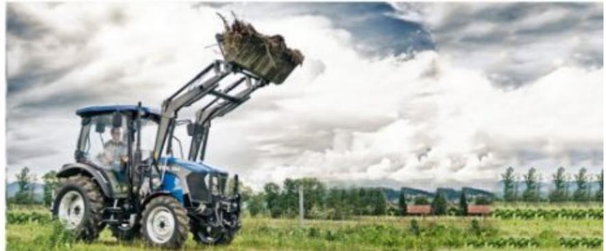
**Industriefrontlader – FL550:** Stabile, werkzeuglos abnehmbare Ladeschwinge mit doppelwirkenden Hubzylindern, Abstellvorrichtung, inkl. Schaufel mit Euro Schnellwechselrahmen, mechanischer Parallelführung, Bedienung über Joystick, robuste Frontlader-Anbaukonsole mit Hinterachsabstützung zzgl. Montagekosten
