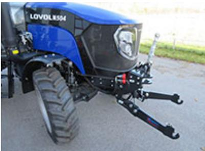
**Frontkraftheber** – Art. Nr. FKH-M354: FH 10-4, doppelwirkend Hubkraft 10kN, Unterlenker Kat. I hochklappbar mit Schnellkuppel-Fanghaken Kat. I inklusive Umschaltventil, doppelt-/ einfachwirkend mit Spindeloberlenker M30 zzgl. Montagekosten
