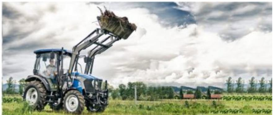
**Industriefrontlader – FL550:** Stabile, werkzeuglos abnehmbare Ladeschwinge mit doppelwirkenden Hubzylindern, Abstellvorrichtung, inkl. Schaufel mit Euro Schnellwechselrahmen, mechanischer Parallelführung, 3. Steuerkreis, Bedienung über Joystick, robuste Frontlader-Anbaukonsole mit Hinterachsabstützung zzgl. Montagekosten
