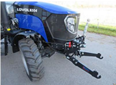
**Frontkraftheber** – Art. Nr. FKH-M504: FH 10-4, doppeltwirkend Hubkraft 10kN, Unterlenker Kat. I hochklappbar mit Schnellkuppel-Fanghaken Kat. I inklusive Umschaltventil, doppelt-/ einfachwirkend mit Spindeloberlenker M30
